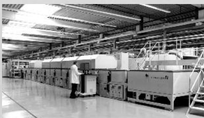
CISARIS Selenisierungssofen für Dünnschicht-Solarzellen
