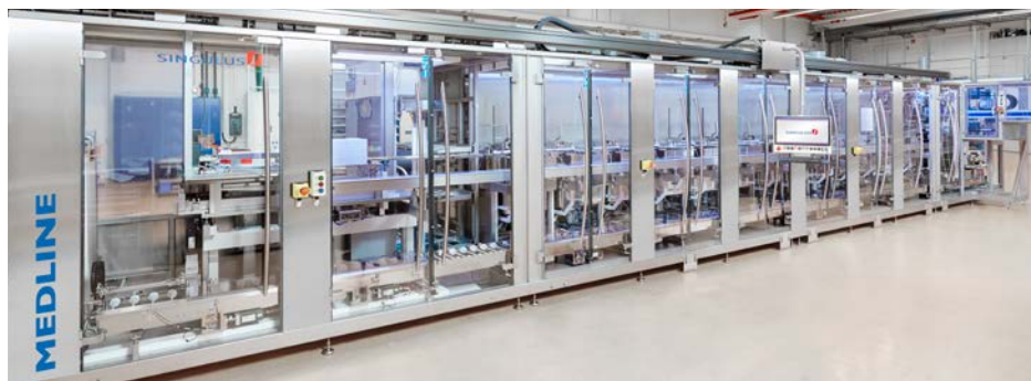
DECOLINE II: Produktionslinie für die umweltfreundliche Veredelung von 3D-Bauteilen in der Automobil-, Sanitär- oder Lifestyle-Industrie, z. B. bei der Metallisierung von Modeartikeln, Knöpfen, Kugelschreibern, Kosmetik oder Tablets und Smartphones. „Decorative Coatings“ eröffnet zahlreiche neue Anwendungen.
