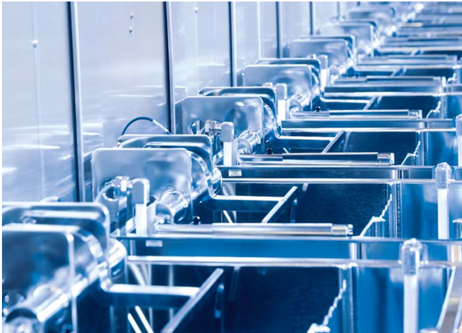
MEDLINE – Innenansicht einer Reinigungs- und Beschichtungsanlage für Tageslinsen.
