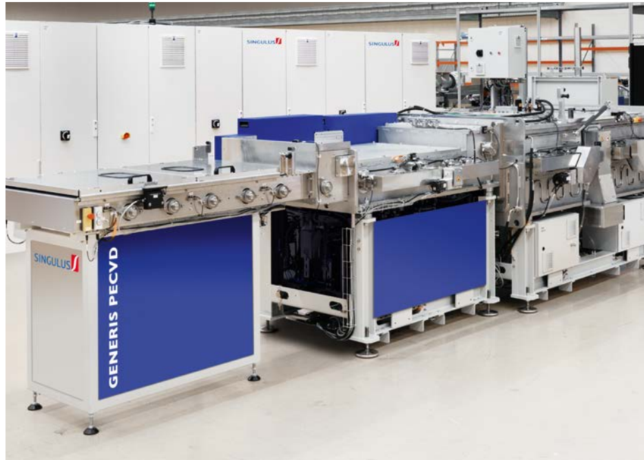
GENERIS PECVD – Produktionsanlage für GaAs-Hochleistungssolarzellen für den Einsatz im Weltraum.
