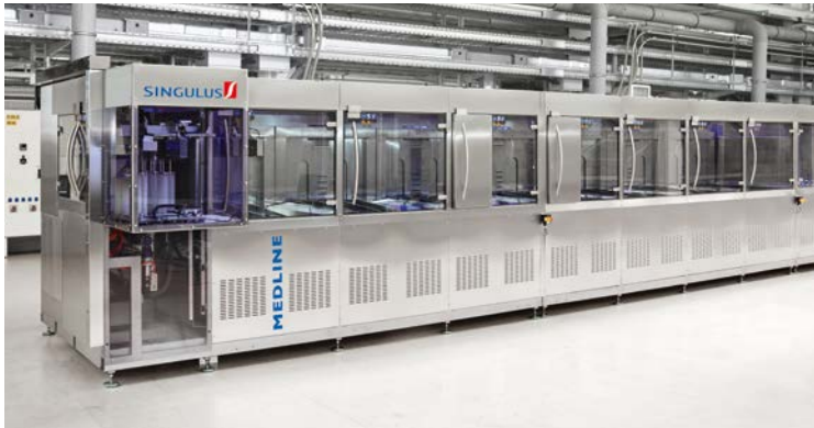
Produktionsanlage für das Reinigen und Beschichten von Tageslinsen
