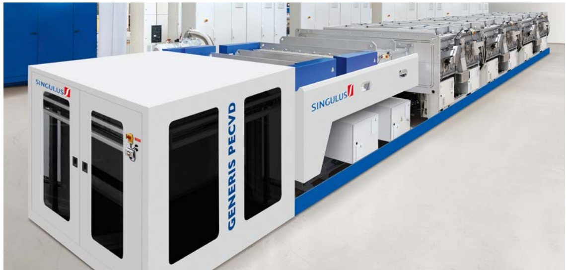
Neu entwickelte GENERIS PECVD Beschichtungsanlage für Hochleistungssolarzellen.
