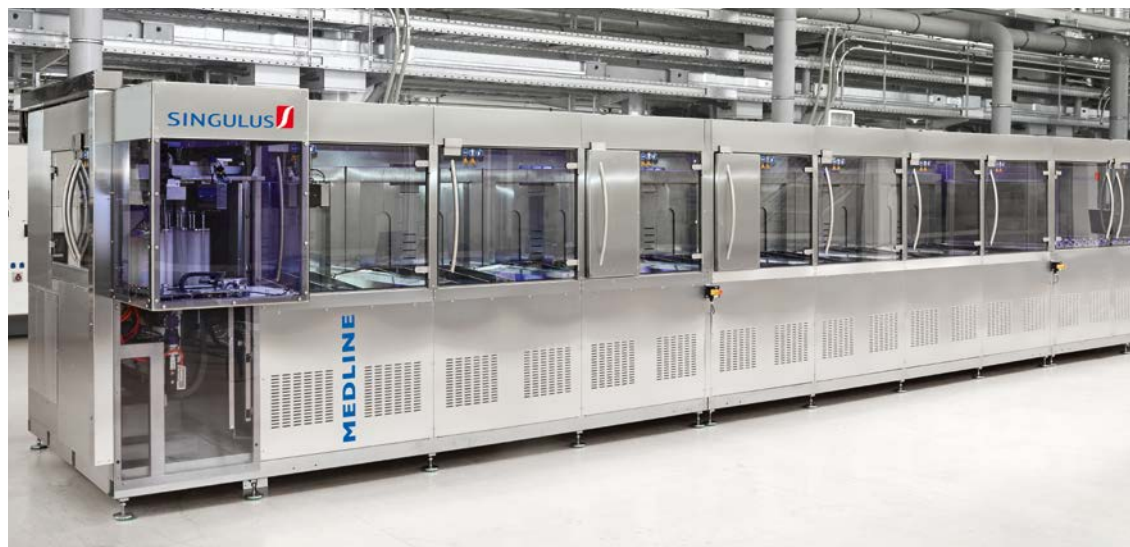
MEDLINE Reinigungs- und Prozessanlage zur Bearbeitung von Kontaktlinsen.
