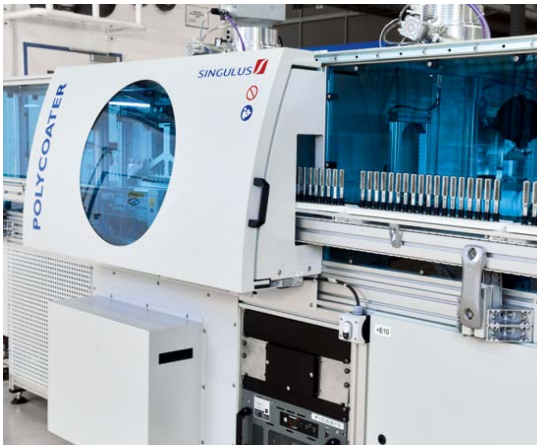
POLYCOATER Inline-Vakuum- Beschichtungsanlage für die nachhaltige Produktion von Gebrauchsgütern für Kosmetik und Automobil.
