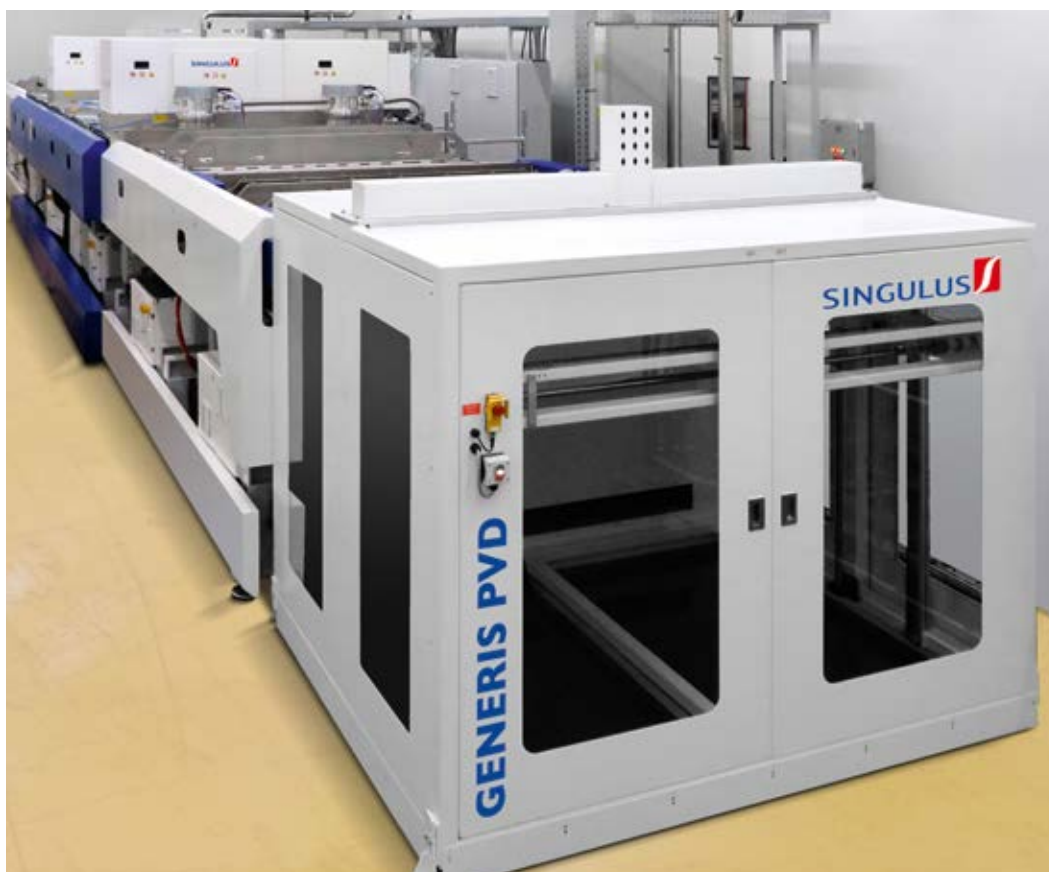
GENERIS PVD Inline-Vakuum- Beschichtungsanlage für die Produktion von Hochleistungs-Solarzellen.
