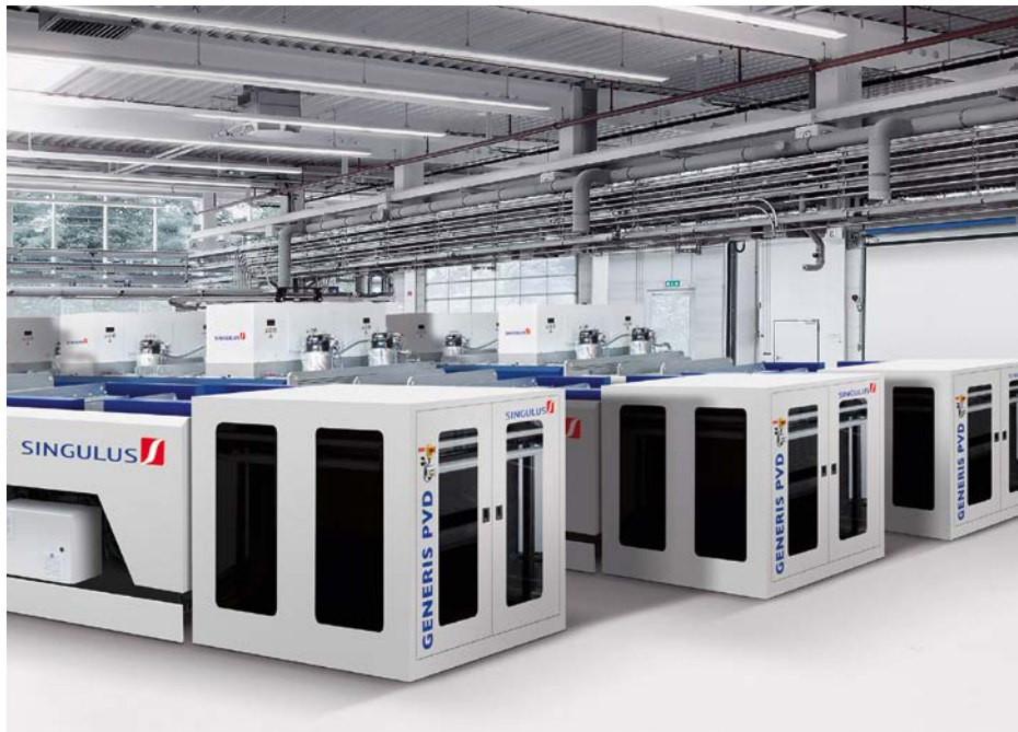
GENERIS PVD – universelle Vakuum-Kathodenzerstäubungsanlage (PVD) für die Beschichtung von flachen Substraten, z. B. für die Solar- und Wasserstofftechnik
