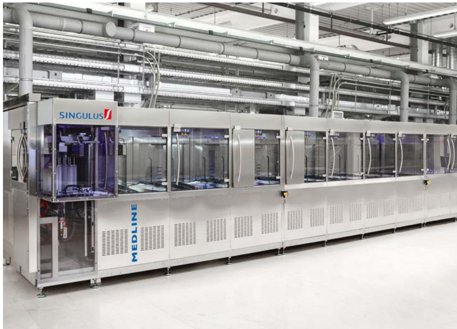
MEDLINE – Prozessanlage für das Reinigen und Beschichten von Kontaktlinsen
