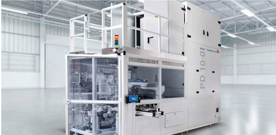
PD Paternoster Dryer – Anlage für die thermische Behandlung von unterschiedlichen Produkten und Baugruppen
