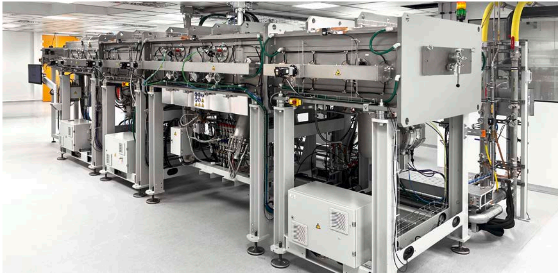
EVARIS – Inline-Vakuum-Aufdampfsystem für die Erstellung von Tandem-PV Solarzellen
